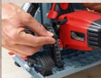
Lo speciale sistema di orientamento con un angolo da da 0° a 45° permette di raggiungere sempre una profondità di taglio massima di 48 mm.
