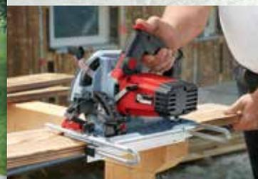
Le guide con scala millimetrica MAFELL e la battuta di riscontro inferiore con scala millimetrica (opzionale) aiutano a tagliare le perline per il terrazzo con la massima precisione.
