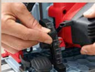
Lo speciale sistema di inclinazione da 0° a 45° permette di raggiungere sempre la profondità di taglio massima di 42 mm (compresa la barra guida).
