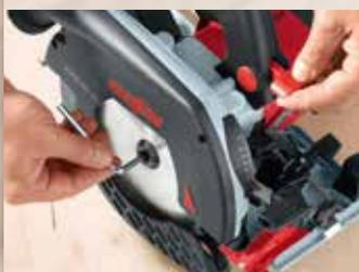
Per cambiare la lama si blocca la sega circolare mediante l'apposito pulsante, in questo modo la lama verrà automaticamente bloccata. Con la chiave a brugola presente sul corpo macchina sarà possibile cambiare la lama rapidamente e in assoluta sicurezza.
