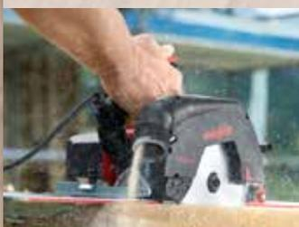
Il sistema di rimozione dei trucioli delle nuove seghe è stato studiato in modo tale da non ostruire il canale di aspirazione. Un vantaggio particolarmente interessante per tagli a immersione lungo la direzione delle fibre.
