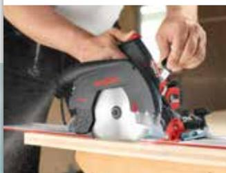
Il dispositivo FLIPPKEIL permette di realizzare tagli a immersione in maniera flessibile e sicura senza dover smontare il divisore.
