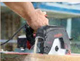
Il sistema di rimozione dei trucioli delle nuove seghe è stato studiato in modo tale da non ostruire il canale di aspirazione. Un vantaggio particolarmente interessante per tagli a immersione lungo la direzione delle fibre.
