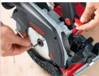
Per cambiare la lama si blocca la sega circolare mediante l'apposito pulsante, in questo modo la lama verrà automaticamente bloccata. Con la chiave a brugola presente sul corpo macchina sarà possibile cambiare la lama rapidamente e in assoluta sicurezza.
