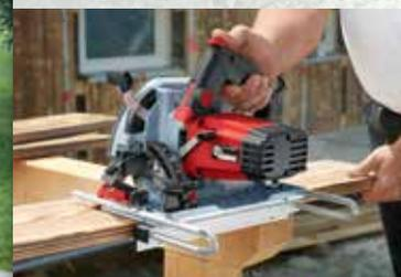
Avec les règles de guidage MAFELL ou le guide inférieur en option munis d'une graduation millimétrique, des sols de terrasse, par exemple, peuvent être ajustés avec précision.
