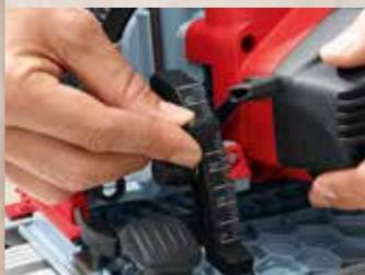
Grâce au système pivotant unique en son genre, une profondeur de coupe de 42 mm (règle comprise) peut être toujours atteinte pour des angles compris entre 0° et 45°.
