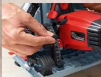
Le système pivotant unique en son genre permet de toujours atteindre une profondeur de coupe de 48 mm pour des angles compris entre 0° et 45°.
