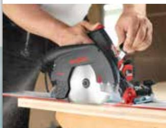
Le couteau diviseur FLIPPKEIL rétractable permet une coupe plongeante sûre, simple et aisée sans qu'il soit nécessaire de le dévisser.
