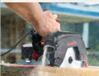
Le guide-copeaux des nouvelles scies a été optimisé de manière à ne pas obstruer le canal d'aspiration. Un avantage de taille lors des coupes plongeantes dans le sens des fibres.
