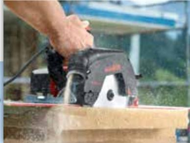
Le guide-copeaux a été spécialement conçu et optimisé pour venir à bout d'un volume extrêmement élevé de copeaux lors de la coupe des matériaux en fibres de bois. Il permet ainsi un travail sans engorgement – même pour des coupes plongeantes dans le sens de la fibre.
