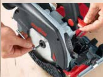
Pour un changement de lame, la lame de la scie est bloquée par simple pression d'un bouton et le blocage de mise en marche est activé automatiquement. La lame peut être alors remplacée aisément et sans danger à l'aide de la clé à six pans fixée à l'appareil.
