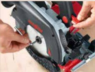
Zum Sägeblattwechsel wird das Sägeblatt einfach per Knopfdruck arretiert und dabei automatisch die Einschaltsperrung aktiviert. Das Sägeblatt lässt sich dann mit dem am Gerät befestigten Sechskantschlüssel sicher und gefahrlos austauschen.
