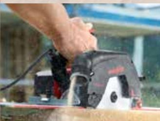
Die Spanführung der neuen Sägen wurde so optimiert, dass der Absaugkanal nicht verstopfen kann. Ein wichtiger Vorteil auch bei Tauchschnitten in Faserrichtung.
