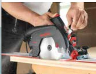
Der FLIPPKEIL ermöglicht – auch ohne Abschrauben des Spaltkeils – einen sicheren, bequemen und einfachen Tauchschnitt.
