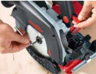
Zum Sägeblattwechsel wird das Sägeblatt einfach per Knopfdruck arretiert und dabei automatisch die Einschaltsperrung aktiviert. Das Sägeblatt lässt sich dann mit dem am Gerät befestigten Sechskant Schlüssel sicher und gefahrlos austauschen.
