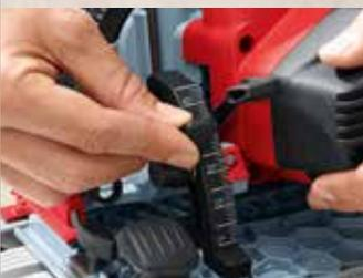
Durch das einzigartige Schwenksystem ist im Winkelbereich zwischen 0° und 45° immer eine Schnitttiefe von 42 mm (inkl. Schiene) erreichbar.
